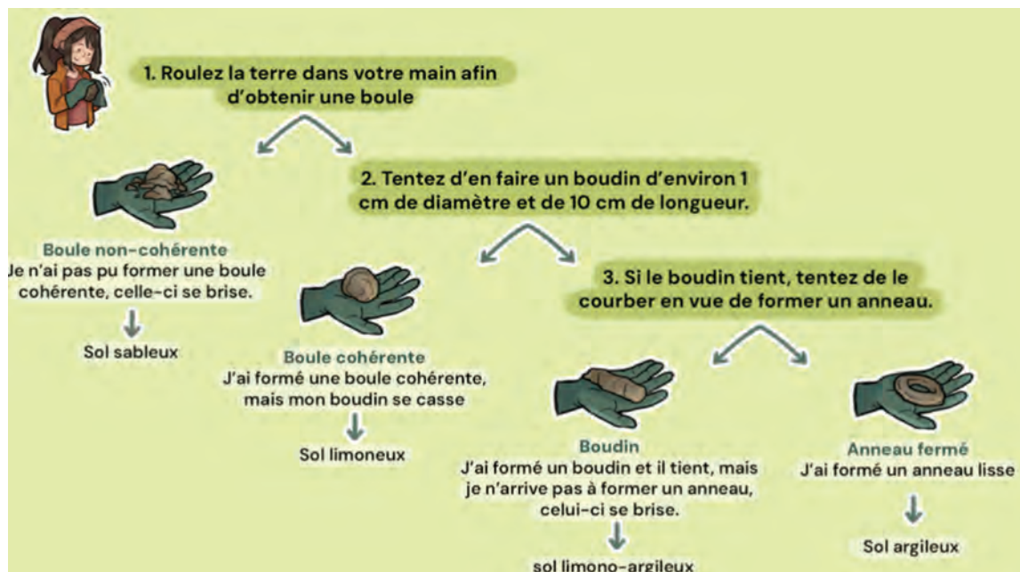
Figure 4 : Test du boudin. D'après IQSW, 2025.
